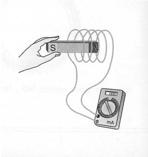
Esperienza. Il solenoide della figura solenoide composto da  $N$  spire è collegato ad un amperometro mediante un circuito che non contiene generatori; pertanto in questo circuito non dovrebbe circolare alcuna corrente. Inserendo un magnete nel solenoide l'amperometro segnala un passaggio di corrente che cessa quando il magnete viene fermato. Se il magnete viene estratto dal solenoide, si osserva ancora un passaggio di corrente ma in verso opposto.
